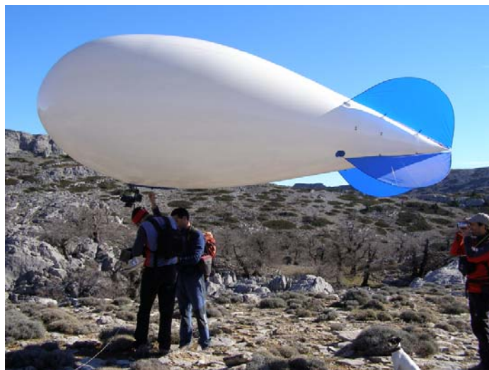
Foto nº 12: Trabajos de geo-fotografía a baja altura con la ayuda de un globo aerostático.
