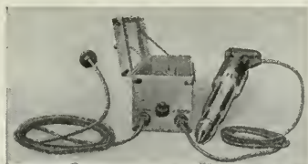
Elektrisk hammare. Weinafhammare med förkopplingsmotstånd.
