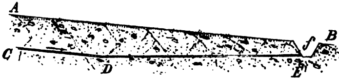
Fig. 147. — Débouché d'un drain dans un fossé d'écoulement.
