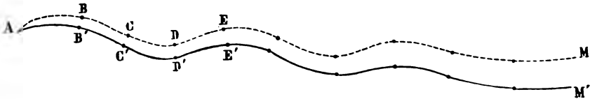
Fig. 127. — Manière de donner de la pente à une rigole.
