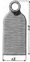
Fig. 123. — Fer de la pioche représentée figure ci-contre, au dixième de la grandeur d'exécution.
