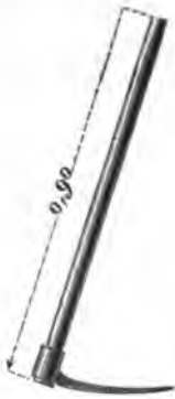
Fig. 122. — Pioche pour vider les rigoles après que les bords ont été tranchés avec la hache.
