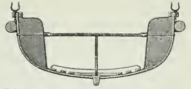
Pelastusveneen poikkileikkans (Oltmannin järjestelmää).
